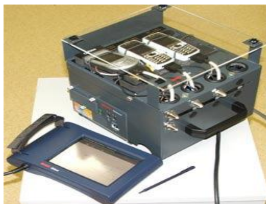
Рис. 4. Измерительно-коммутационный блок комплекса QVoice вместе с панелью управления.
