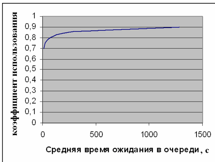
Рис. 5 Время задержки трафика маршрутизатором при обслуживании с приоритетом.
